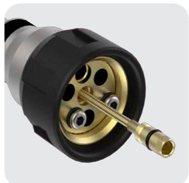
**Cuellos intercambiables.** Compatibilidad total y amplia gama de sopletes. Sistema de cambio de cuello roscado, rápido y sencillo con circuitos independientes y válvulas automáticas de corte de líquido.
